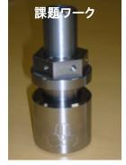
旋盤の操作技術についても、汎用・NCを問わずに多くを学ぶことができる研修カリキュラムである。課題のワークとして、初級レベルのものから中央職業能力開発協会による技能検定の実技に出題されたものにまで取り組める。旋盤作業の基礎基本は勿論、生爪成形やテコ式ダイヤルゲージによる測定等、実践的な作業技術も身につけることができる。そして、自分の技術の足りない箇所を明確にすることができる、とても充実した内容のものである。
