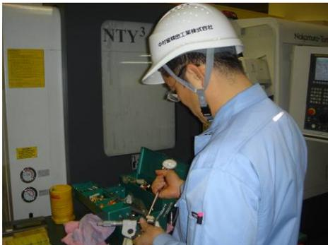
写真3 寸法測定の様子
