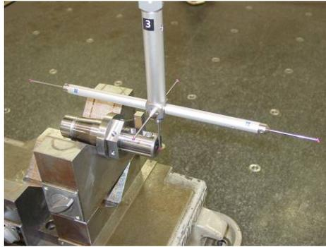
写真2 ワークの3次元測定
