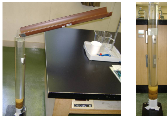
制作教材③川から流れてきた小石、砂、粘土が水のはたらきによって層になることを確かめさせるためのモデル実験教材
