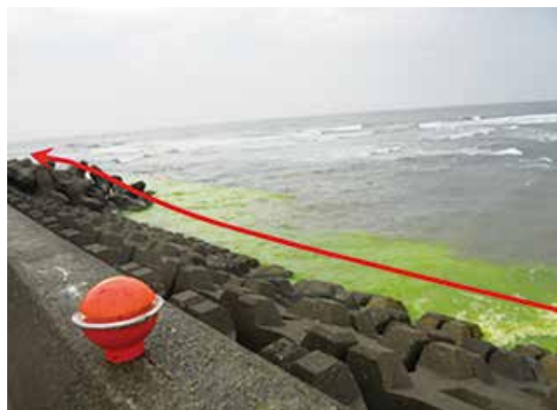
図22 着色剤（シーマーカー）による離岸流の調査の様子 防砂堤沿いに、流れが続いている
