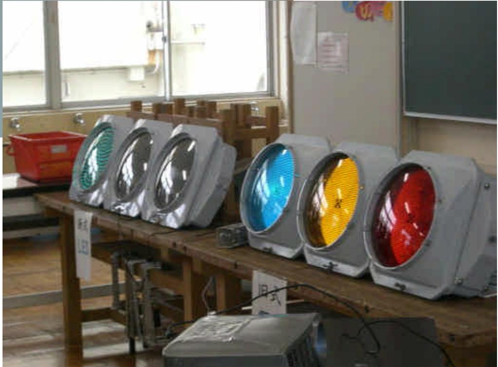
※ LED の信号機に比べ、旧の信号機は逆光により、3つとも点灯しているように見える。
