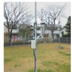
地上気象観測装置で自動的に常時観測していて、気象台の敷地内にある「露場（ろじょう）」と呼ばれる広い芝生に設置してある。
